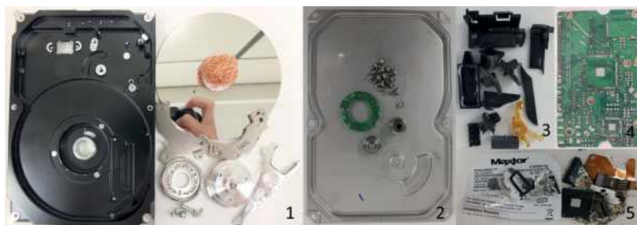
Figura 5: Segregação do HD por tipo de material: 1 – Metais não ferrosos, 2 – Metais ferrosos, 3 – Plásticos, 4 – Materiais com substâncias de interesse, 5 – Outros materiais.
