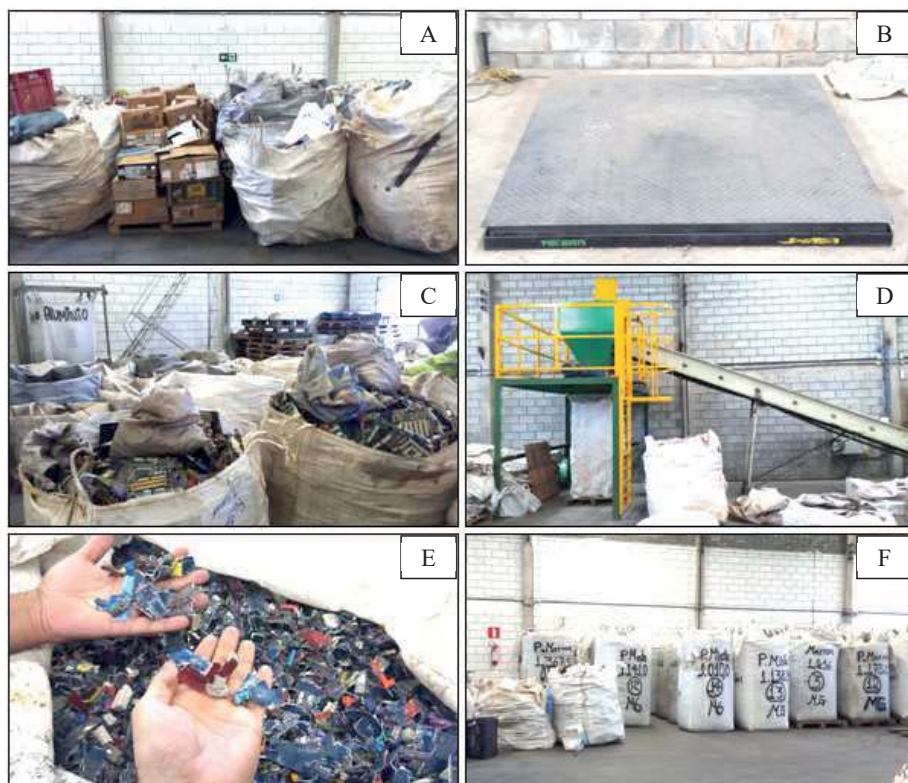
Figura 6 – Estrutura operacional da empresa especializada em classificação dos REE: A – Recebimento de material; B – Pesagem; C – Triagem e classificação; D – Trituração; E – PCI triturada; F – Material acondicionado
