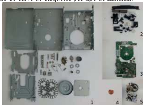
Figura 2: Segregação do drive de disquetes por tipo de material: 1 – Metais ferrosos, 2 – Plásticos, 3 – Materiais com substâncias de interesse, 4 – Metais não ferrosos, 5 – Outros materiais.
