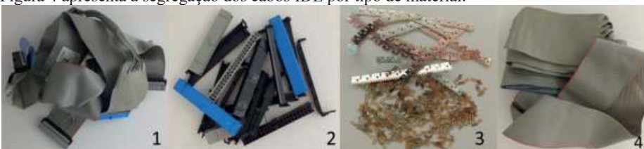
Figura 4: 1 – Cabos IDE montados. Segregação dos cabos IDE por tipo de material: 2 – Plásticos, 3 – Metais não ferrosos, 4 – Fios e cabos.
