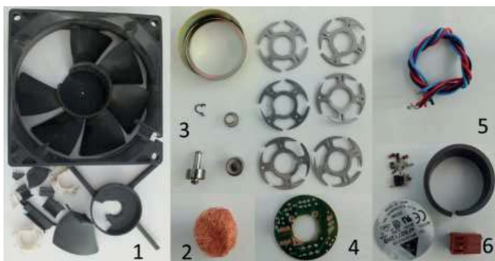
Figura 6: Segregação do cooler por tipo de material: 1 – Plásticos, 2 – Metais não ferrosos, 3 – Metais ferrosos, 4 – Materiais com substâncias de interesse, 5 – Fios e cabos, 6 – Outros materiais.
