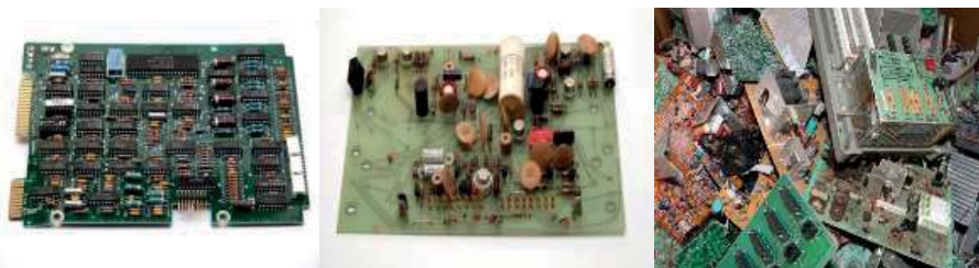
Figura 1: modelos de PCI - a) material de alta qualidade, com “fingers”, pinos e circuito integrado; b) material de média qualidade; c) material de baixa qualidade.
