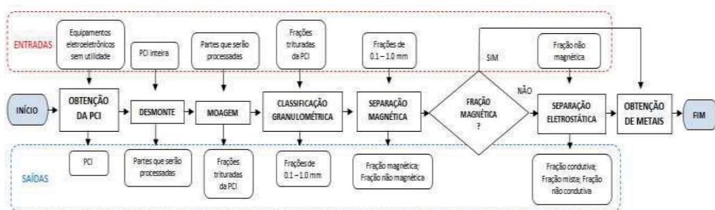
Figura 3: Fluxograma das etapas de recuperação de metais de PCIs através de processamento mecânico.
