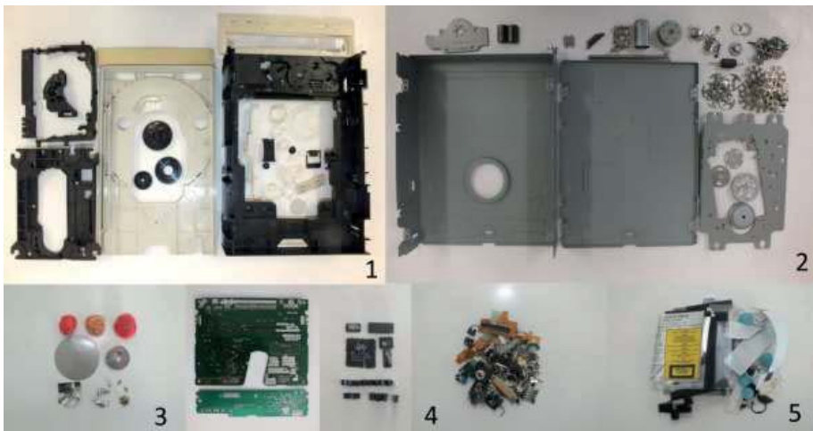
Figura 3: Segregação do drive de disquetes por tipo de material: 1 – Plásticos, 2 – Metais ferrosos, 3 – Metais não ferrosos, 4 – Materiais com substâncias de interesse, 5 – Outros materiais.
