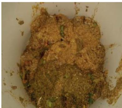
Figura 1 - FORSD após trituração.
