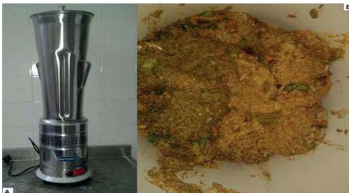
Figura 2 – Trituração dos resíduos orgânicos – A - Liquidificador industrial de aço inox com capacidade de até 10 L, utilizado para triturar o resíduo orgânico coletado. B: Substrato após trituração, apto a ser utilizado nos testes.
