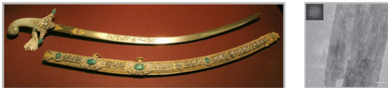
Figura 4: À esquerda o sabre de Damasco (foto de Tina Fineberg para The New York Times) e à direita imagem de microscopia eletrônica de transmissão de alta resolução de nanotubos de carbono.
